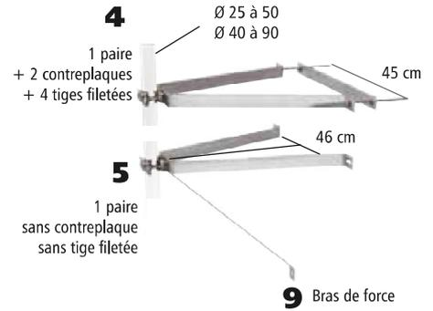
**+** - Fixation renforcée du mât par mâchoires et étriers crantés.
